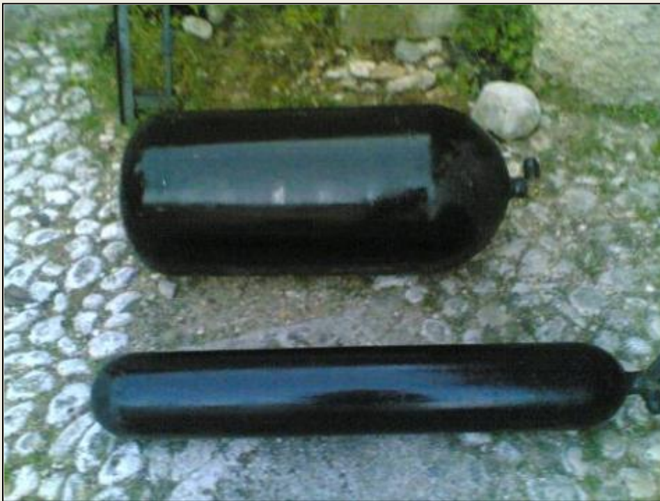
Serbatoi di metano compresso
