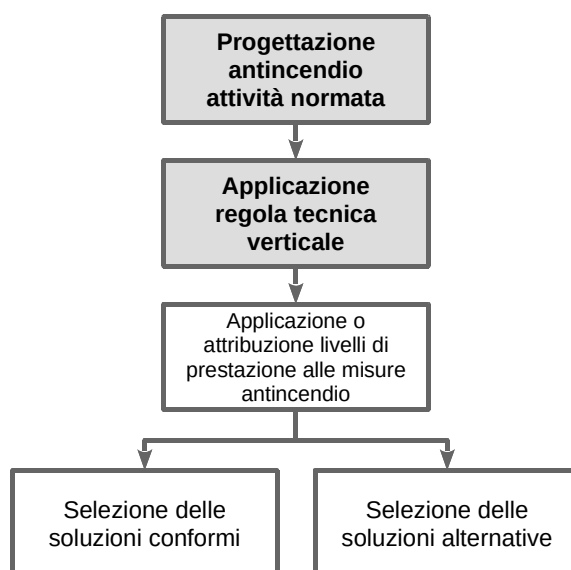
Illustrazione G 2.3: Progettazione antincendio delle attività normate
